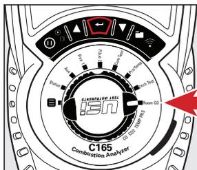
Aucun raccord de sonde ou de tubulure n'est nécessaire pour ce test.
